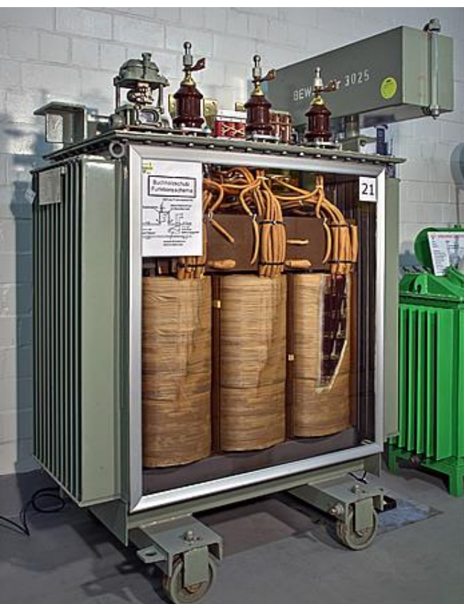
Blick in einen aufgeschnittenen Netztransformator
