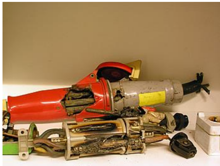
Durch Kurzschluss zerstörte Drehstromverbindung
