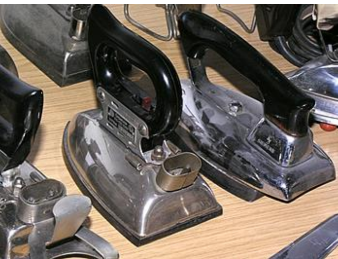
Haushaltsgeräte ohne Schutzkontakt
